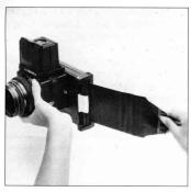
E. 黄夕ブをポラロイドバックEから、まっすぐ静かに引き出します。 黄夕ブを引き出しきったときから現像が始まります。引き出す早さはどのくらいかと言えば「引き出す」とで普通の早さで言う時間ぐら出るいであれば引き出しかたが早いからであれば引き出しかたが早いからで、もう少しゆっくりします。 E. Pull the yellow tab straight, moderately fast; in one smooth uninterruped action. Development starts when the yellow tab has been pulled completely out and, therefore, start timing development from that point. If the developed print is full of white specks, slow down a little as you are pulling too fast.
