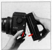
B. カメラボデイの着脱ボタンを押すと、ポラロイドバック E は、下方から矢印の方向にはずれます。
