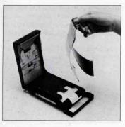
C. フイルムバックから、その一枚を引き抜いたならばこれは捨てます。 裏蓋の開いている間にローラーが汚れていないか点検してください。 C. Draw the yellow tab completely out of the pack film and discard it. While the Polaroid Film Back E is open, check the rollers and see if they are clean.
