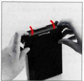
B. 白タブがスリットから出ている ままで、裏蓋をもとどおり両側でし っかり押しつけて閉め、ロックレバ ーでロックしてください。 B. Close the front plate securely, by pressing on both sides strongly, with the white tab sticking out of the small slot, and fix the lock lever securely.
