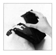
C. タイプ87、88フイルムを使用したときの操作は前項「フイルムパックの装塡」で説明したように、フイルムは裏蓋に押されて固定しています。したがって、裏蓋を開けるとフィルムがはずれないように、必ずフィルム面が下にくるような向き、まった開いてください。このとき、フィルムパックが枠より浮き上がらない。よう指で押えて操作してください。
