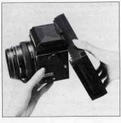
A. カメラからフイルムバックをはずし(ETRSカメラ使用説明書8頁「フイルムバックの着脱」の項参照)カメラボディ上部の取りつけ穴にポラロイドバックEの上部金頁をさし込み、下部をカメラボデイに押しつけます。
