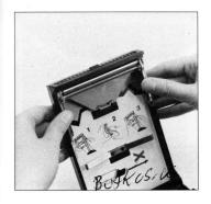
D. そして裏蓋内部のホコリをよく 吹きはらい、最後にローラーのアセ ンブリーを戻しておきます。 D. Use an air-blower and clean out the inside of the rear cover, before returning the roller assembly to its place.
